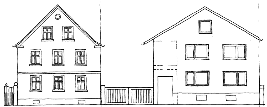
Stehende statt liegende Fensterformate, Holzfenster statt Plastikfenster
